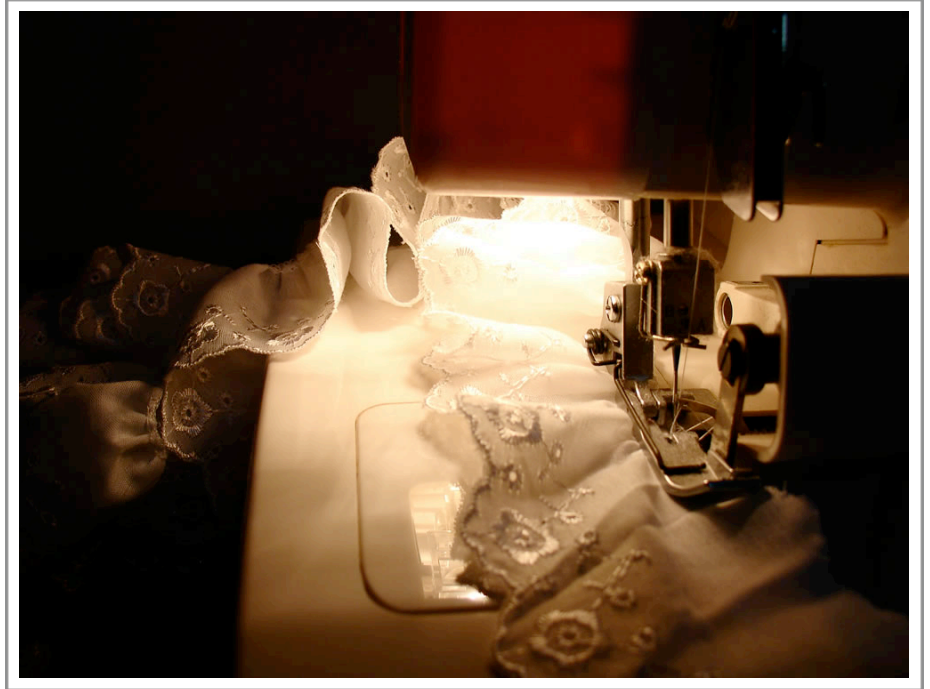
FIGURA 4.7: Costura con la máquina de “overlock”.
